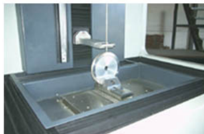
Particolare della mensola porta-guidatubetti posizionata in prossimità del pezzo da forare
