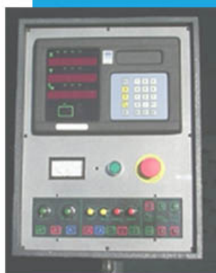
Consolle di comando con visualizzazione di quote a tre assi
